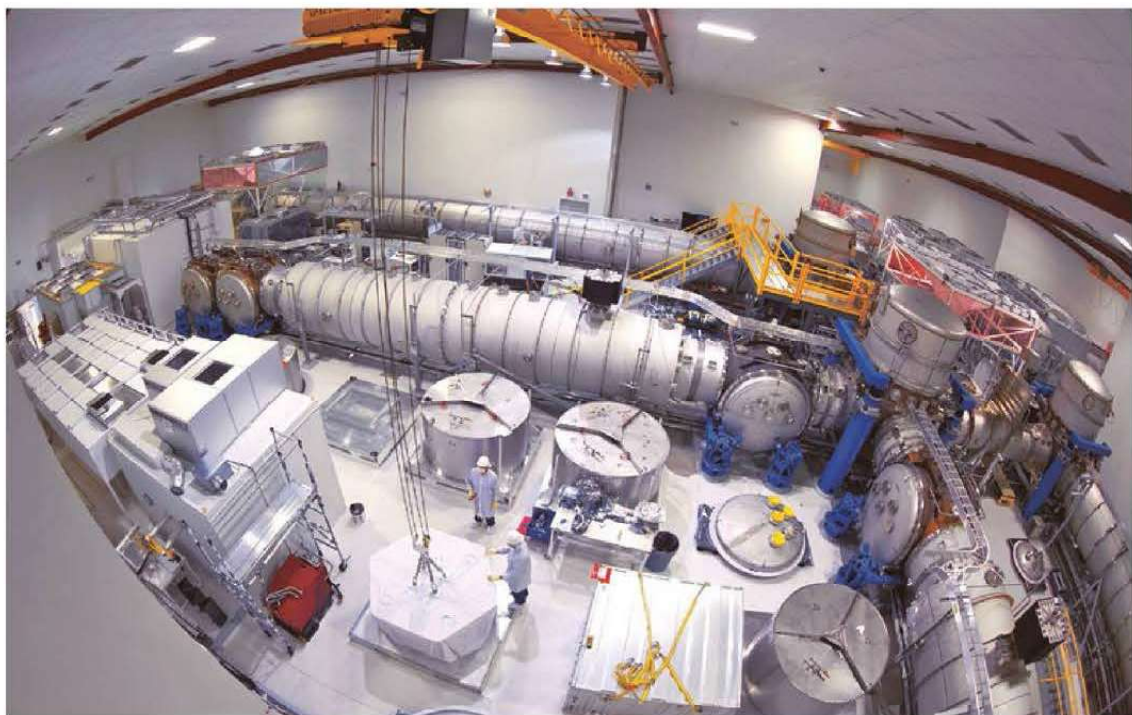
En la imagen, equipos láser y de vacío en el Observatorio de Ondas Gravitacionales por Interferometría Láser (LIGO) para detectar ondas gravitacionales cósmicas.
